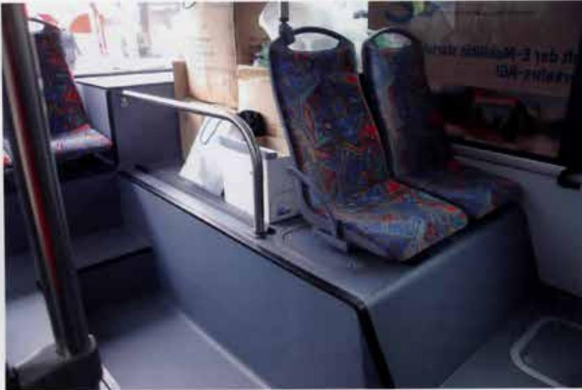
Bild 7: Links im Heck des Solaris steht die Speicherbatterie unter einer Abdeckhaube, auf der zwei Sitze montiert sind
