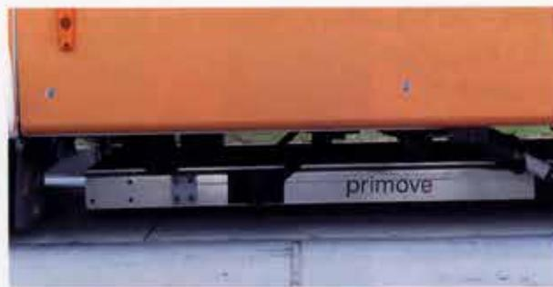
Bild 3: Der kleine Rampini hat sein Lademodul zur Ladeplatte abgesenkt (Bild: BSVAG)
