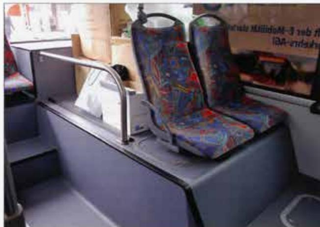
Links im Heck des Solaris steht die Speicherbatterie unter einer Abdeckhaube, auf der zwei Sitze montiert sind.
