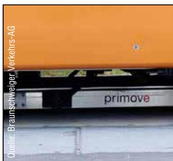
**Induktiv: Energieaufnahme über ein Aufnahmepad**
