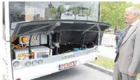
**Andreas Glaser, Leiter Bus der Verkehrs-AG, öffnet die Heckklappe. Dort befindet sich nicht der Motor, sondern Batterien und Kühlung.**
