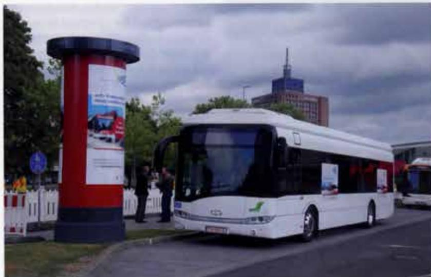
Bild 1: Solaris Urbino 12 electric mit der in einer Litfasssäule untergebrachten Kühleinheit für Ladestation 2 am Hauptbahnhof (alle Bilder, soweit nicht anders gekennzeichnet: Christian Marquardt)
