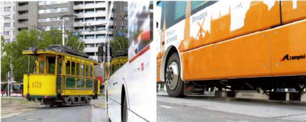
Links: Oldtimerwagen 103 schlug die Brücke von der ersten elektrischen Straßenbahn zur ersten rein elektrisch gefahrenen Buslinie in Braunschweig. Rechts: Ausgefahrenes Ladepad unter dem Bombardier-Laborbus. Unten: Die Ringlinie 12 mit den Ladestationen.
