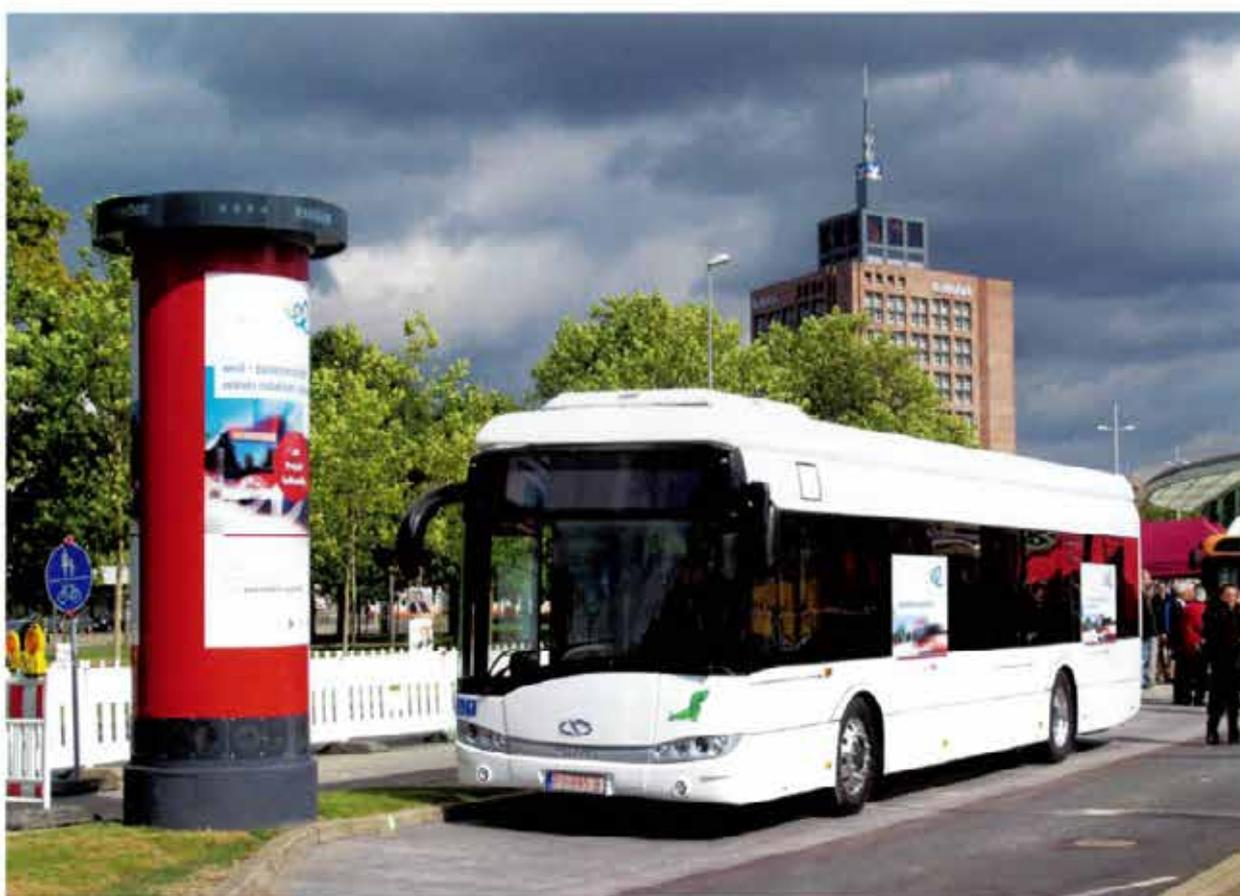
Solaris Urbino 12 electric an der neuen Haltestelle mit Ladestation. In der Litfaßsäule stecken die Kühleinheiten für die Leistungselektronik.
